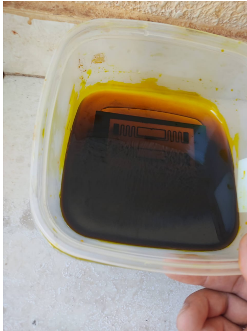
Figura 27 – Processo de Corrosão
