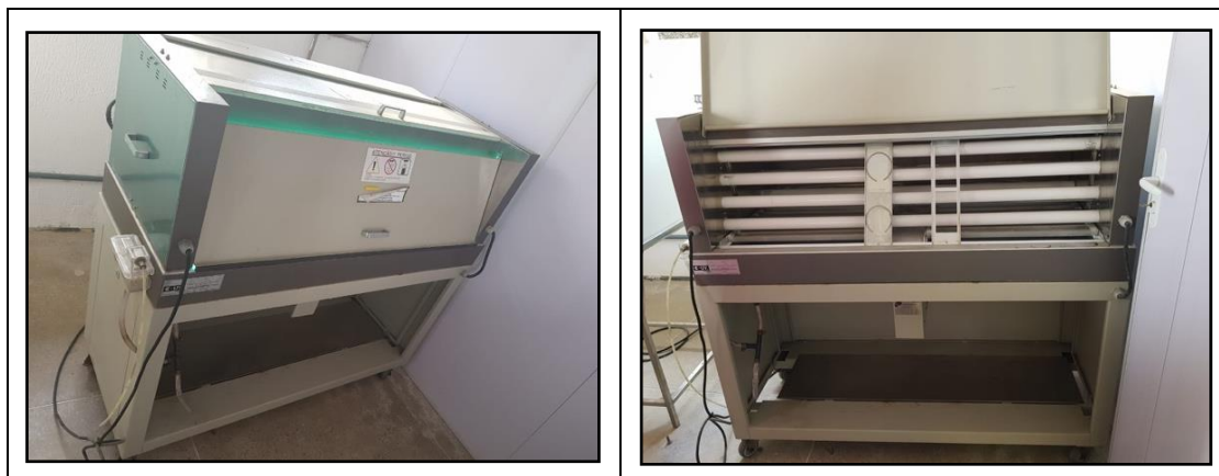
Figura 9 - Câmara de envelhecimento equipadas com lâmpadas fluorescente UV-B.
