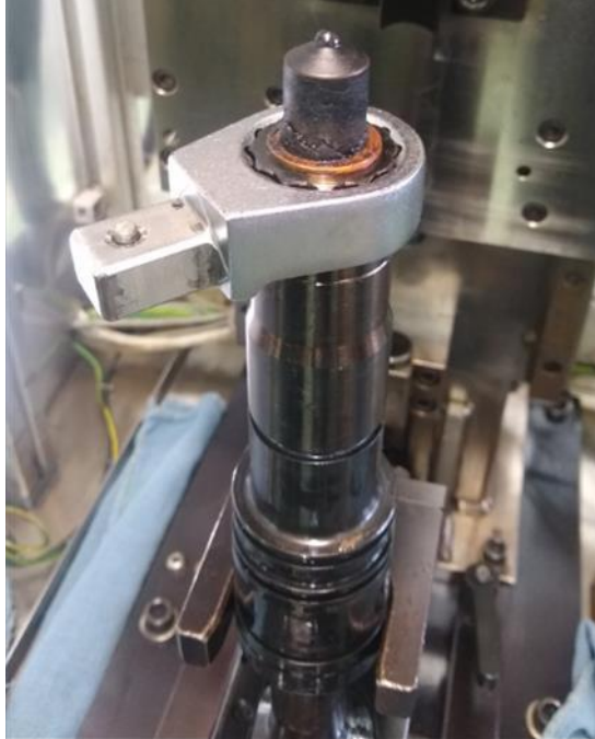
Figura 17 – Modo de fixação para desmontagem do injetor
