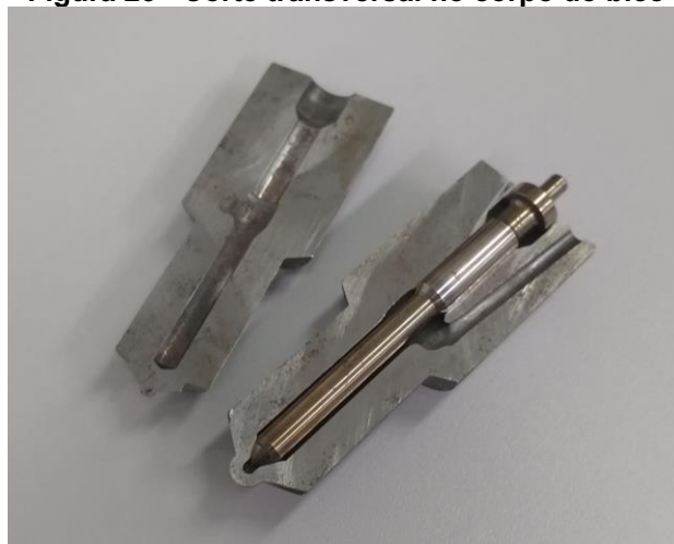
Figura 23 - Corte transversal no corpo do bico
