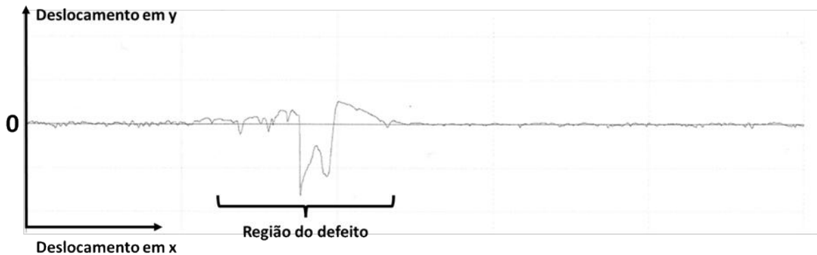
Figura 34 - Perfil de rugosidade da região do assento do corpo do bico
