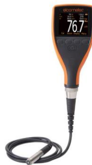
Figura 31 – Equipamento Elcometer 456 para mensurar espessura de camada
