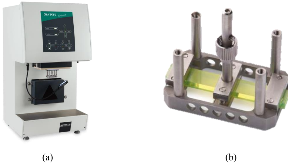
Figura 29 – (a) Equipamento NETZSCH modelo DMA 242 E Artemis e (b) suporte do tipo flexão em cantilver.
