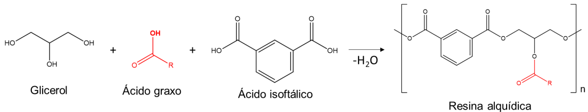
Figura 12 – Exemplo de reação de polimerização via ácidos graxos
