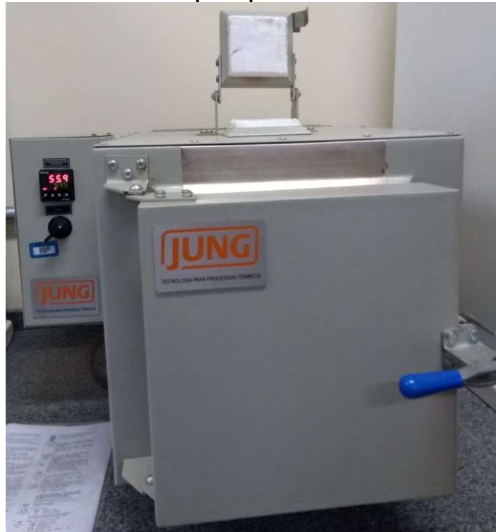
Figura 3 - Forno mufla com controlador automático de tempo e temperatura para programas de rampas e patamares.
