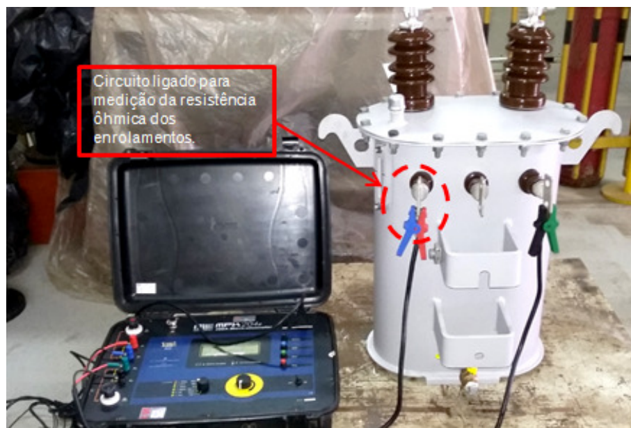
Figura 33 – Medição da resistência elétrica dos enrolamentos. Fonte: Autoria própria.
