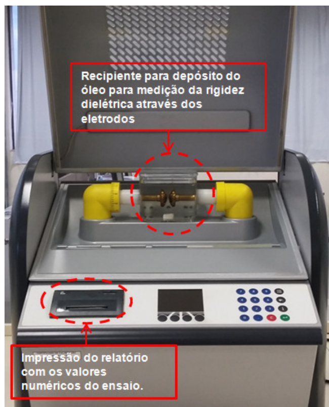
Figura 14 – Equipamento para ensaio de rigidez dielétrica (Modelo: Baur Oil Tester DTA, Fabricante: Baur). Fonte: Autoria própria.
