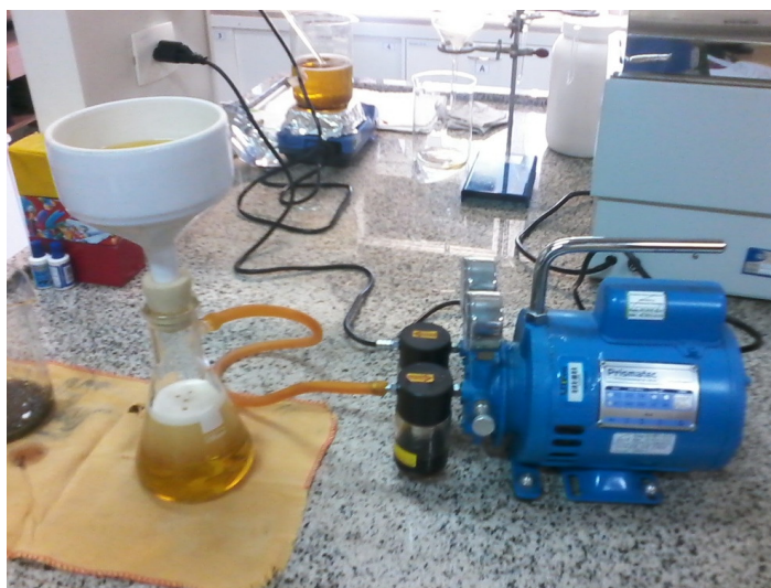
Figura 18 – Processo de filtração do óleo de tungue com Terra Fuller. Fonte: Autoria própria.
