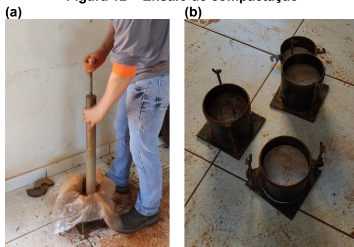
Figura 12 – Ensaio de compactação
