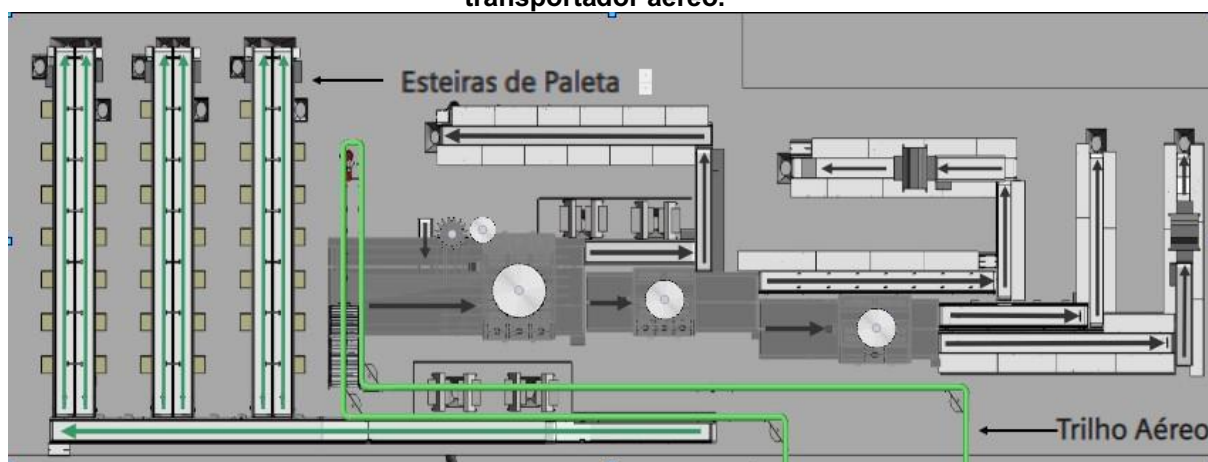
Figura 3 - Representação do setor de desossa tendo em destaque as esteiras de paleta e o transportador aéreo.
