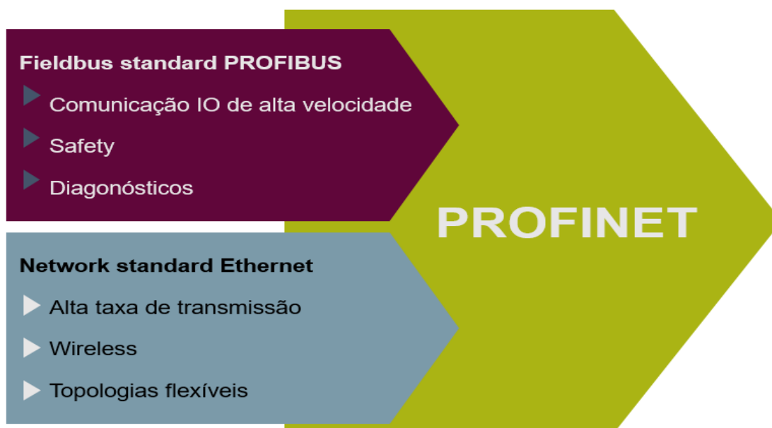
Figura 29 – Representação da descrição da rede profinet e suas vantagens
