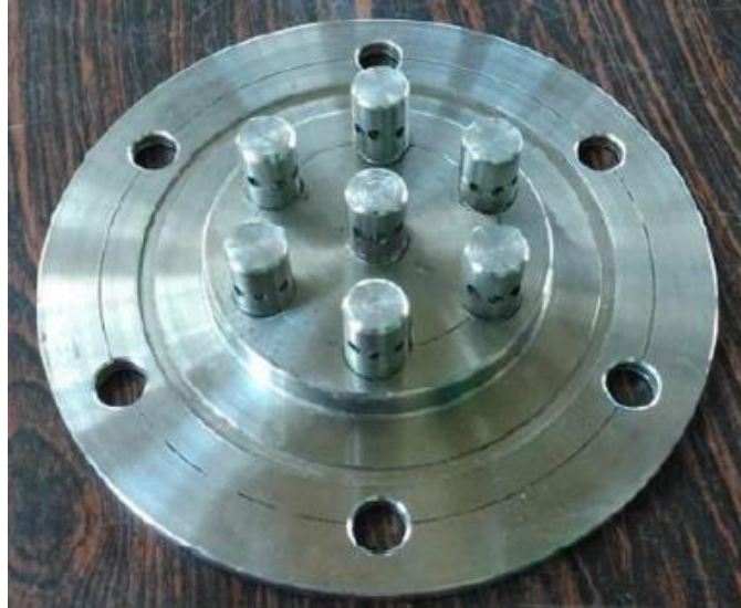
Figura 16–Placa distribuidora de ar do tipo tuyere instalada na UFRAF
