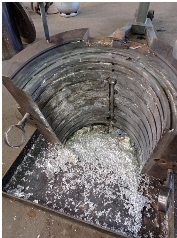
Figura 16 – Remoção do metal de revestimento por aquecimento.
