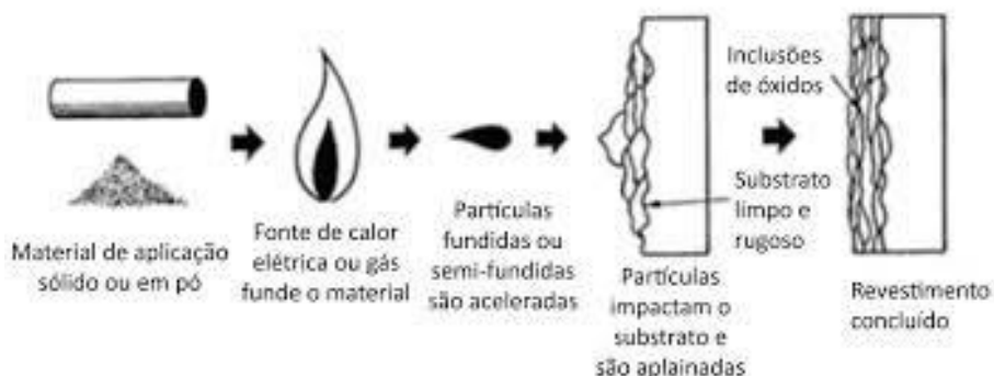
Figura 8 – Processo de aspersão térmica.
