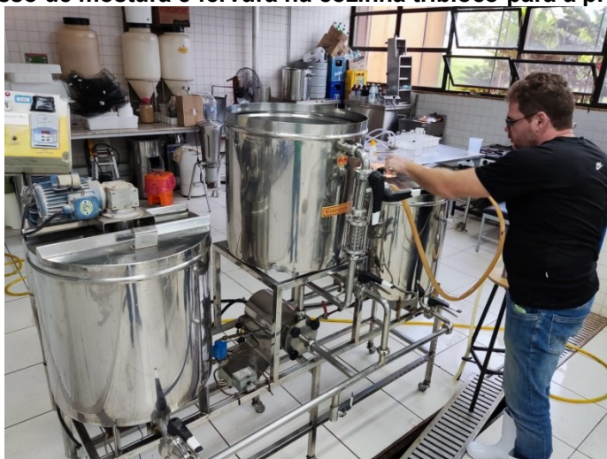
Figura 3 - Processo de mostura e fervura na cozinha tribloco para a produção do chope
