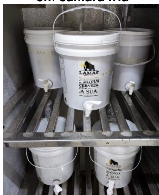
Figura 4 - Fermentadores com as amostras de 20 a 70 IBU durante o processo de fermentação em câmara fria
