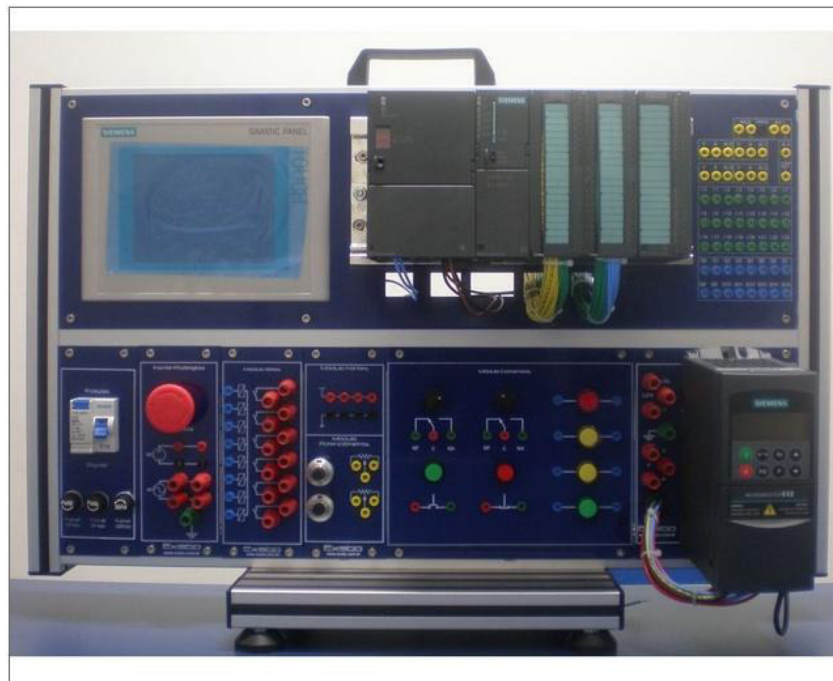
Figura A1: Kit didático da Exsto utilizando CLP S7-300
