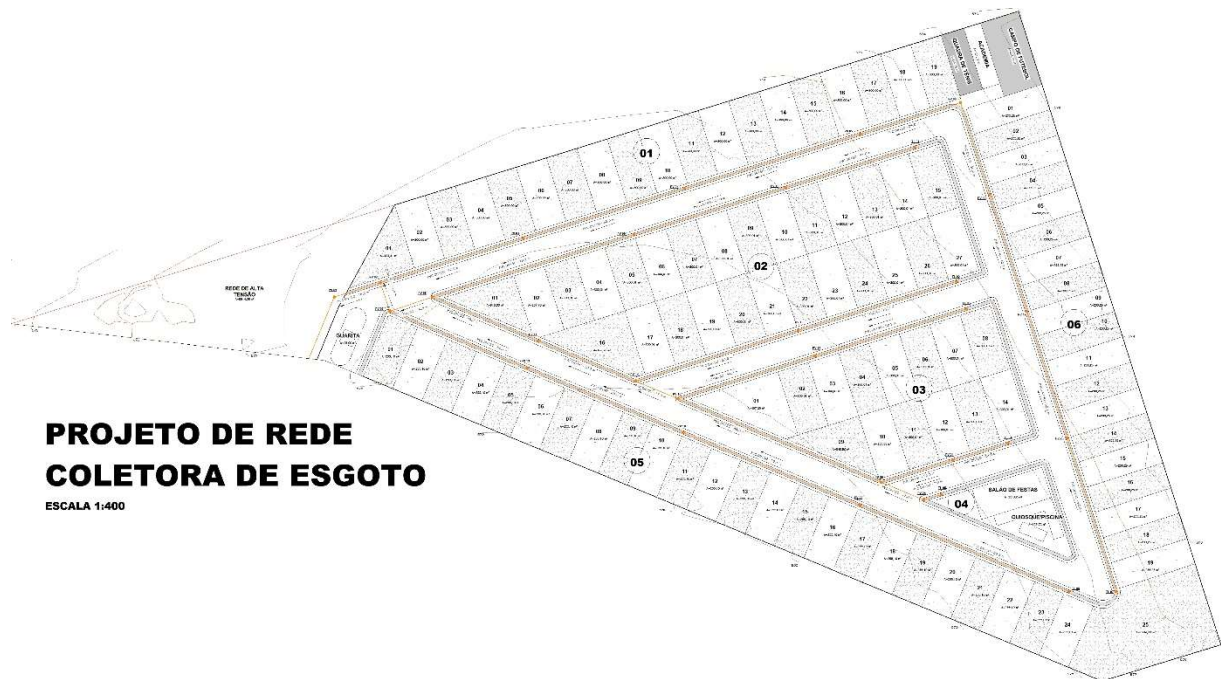
Figura 5 – Projeto de rede coletora de esgoto
