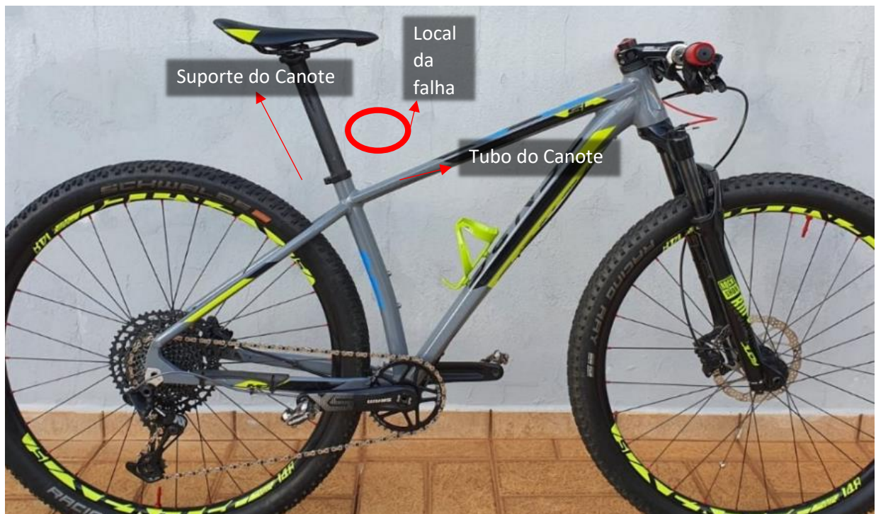
Figura 16 – Local da falha evidenciado
