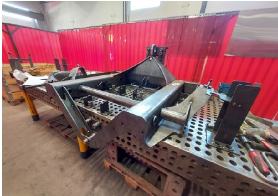
Figura 43 - Quadro Central Fixo Ponteado
