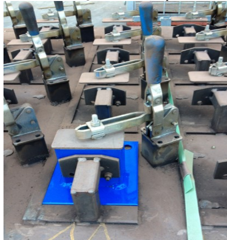
Figura 19 - Utilização de Grampos de Fixação
