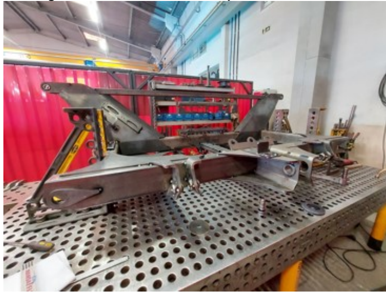
Figura 45 - Quadro Central: Etapa 2 de Ponteamento
