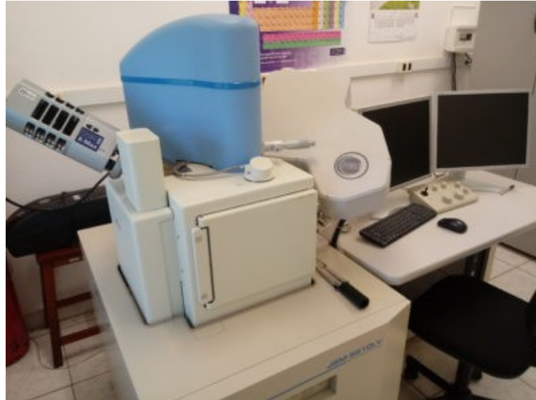
Figura 20 – MEV JEOL JSM-6610LV da USP de Ribeirão Preto
