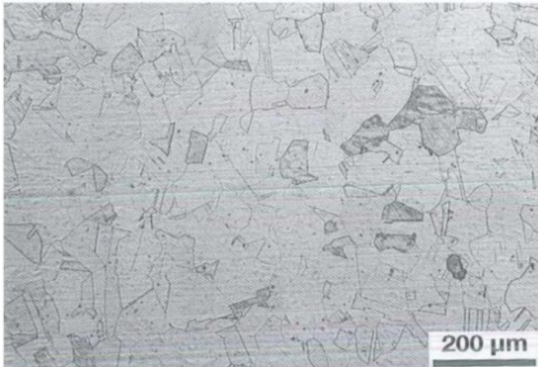
Figura 2 – Microestrutura típica de um aço inoxidável austenítico
