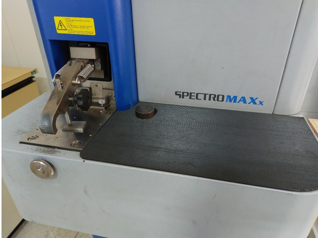
Figura 15 – Espectrômetro SpectroMax utilizado para análise química dos cupons
