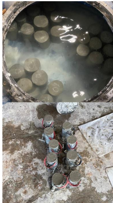
Figura 16: Produção e armazenamento dos corpos de prova
