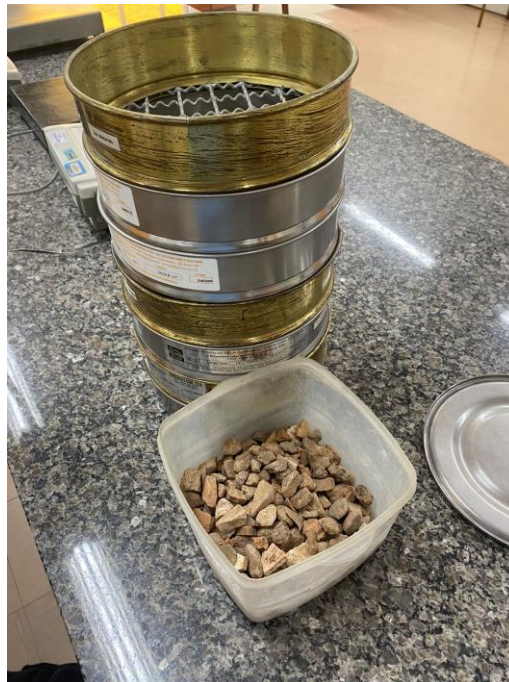
Figura 10: Ensaio de granulometria ARM.
