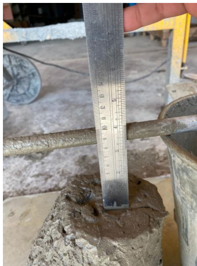
Figura 15: Realização da medição de abatimento do concreto
