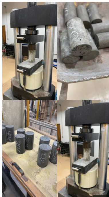
Figura 19: Ensaio de resistência a compressão.
