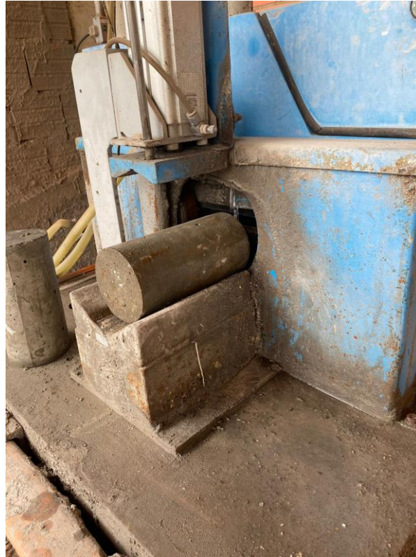
Figura 18: Retificação dos corpos de prova.
