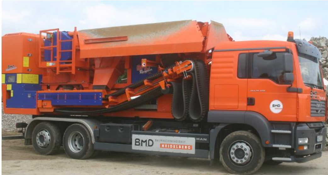
Figura 5: Usina móvel completa de resíduos
