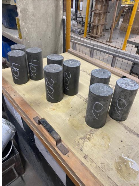
Figura 17: Corpos de prova desmoldados
