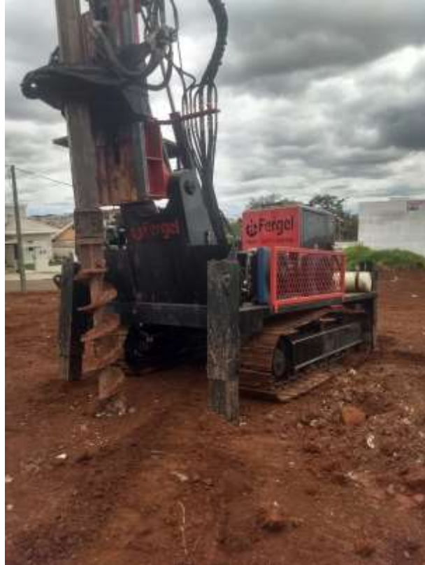
Figura 9:Perfuratriz para estacas escavadas
