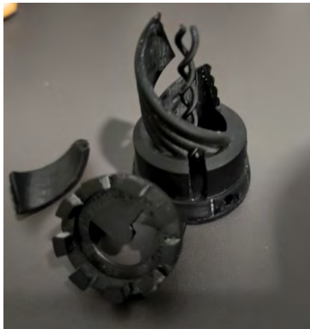
Figura 53 – Falha ocorrida por pós processamento
