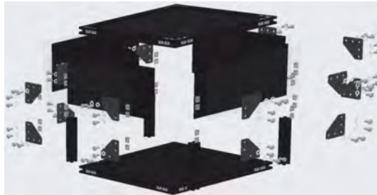
Figura 33 – Posicionamento dos painéis superiores e inferiores
