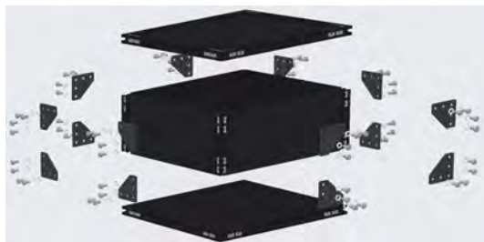
Figura 34 – Montagem dos painéis laterais
