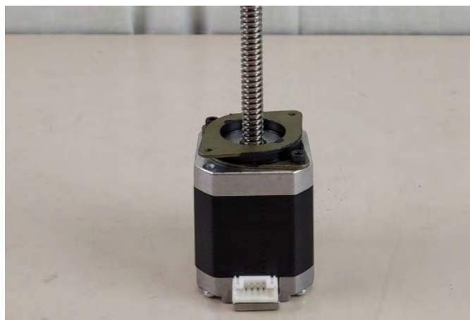
Figura 18 – Conjunto NEMA 17 com rosca sem fim e amortecedores
