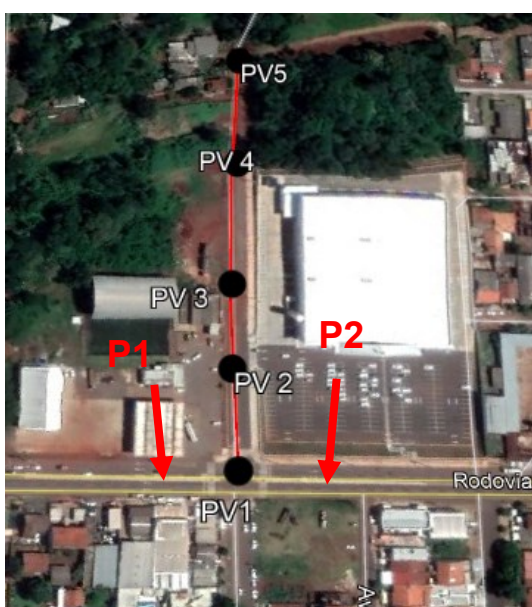
Figura 8 - Ponto crítico de alagamento
