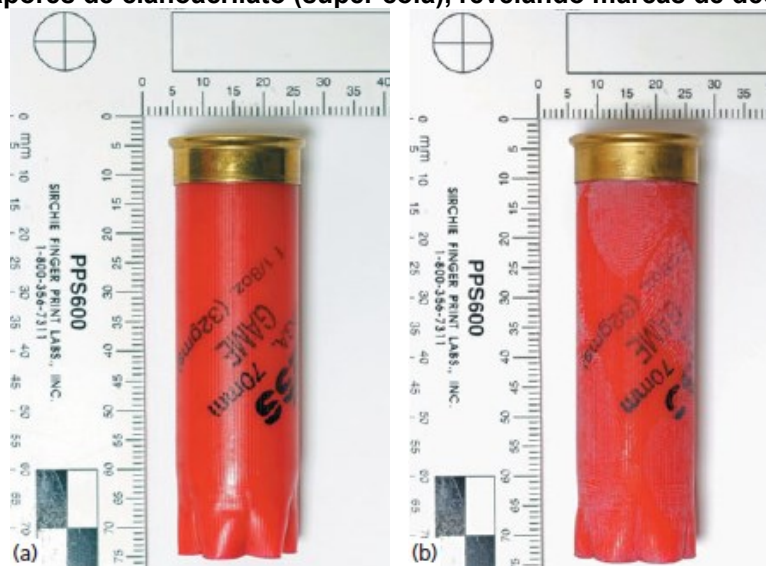
Fotografia 1 - Um cartucho de espingarda disparado: (a) sem tratamento, e (b) tratado com vapores de cianoacrilato (super cola), revelando marcas de dedos
