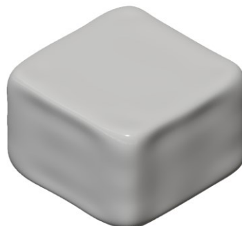
Figura 21 – Solução proposta pelo Fusion 360 no DG quando projeto foi submetido a carga de 11.869 N
