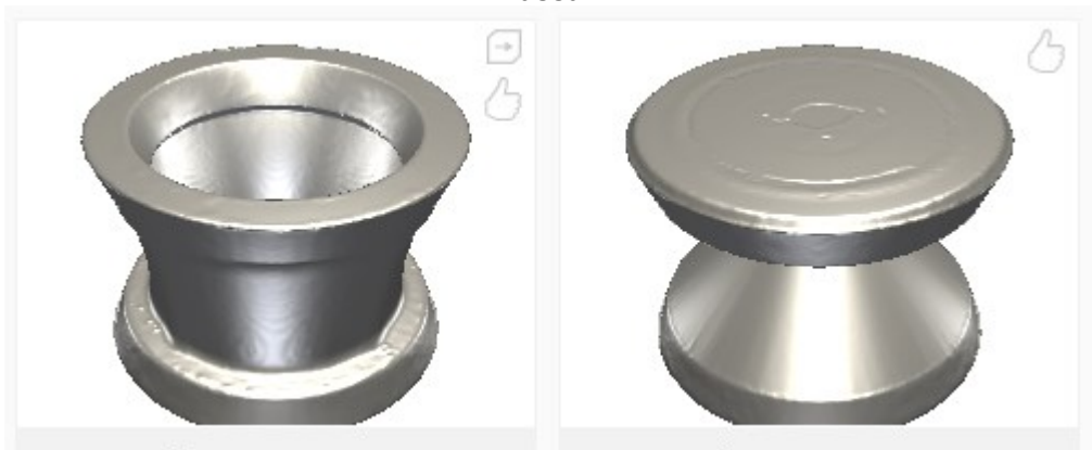
a) b) Figura 13 – Dois tipos de objetivos para geração do DG, (a) maximiza a rigidez (b) minimiza massa
