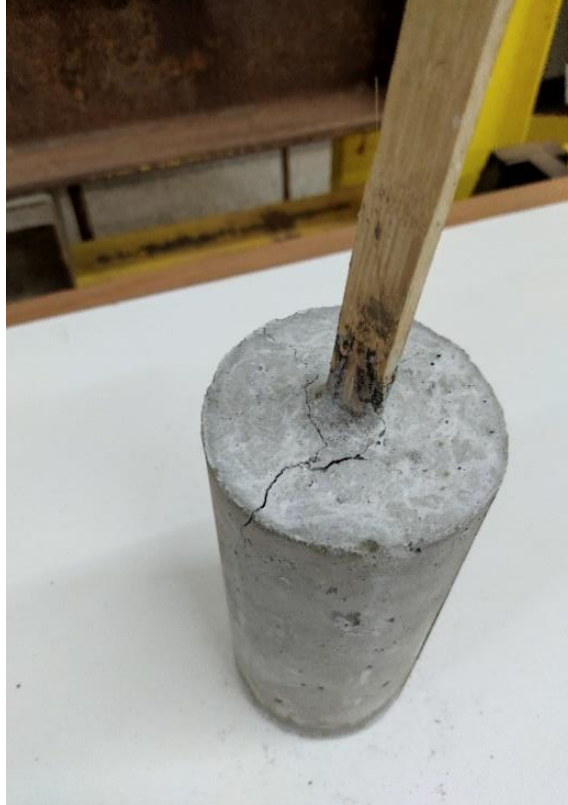
Figura 62 - Corpo de prova Asx5 apresentou ruptura no concreto
