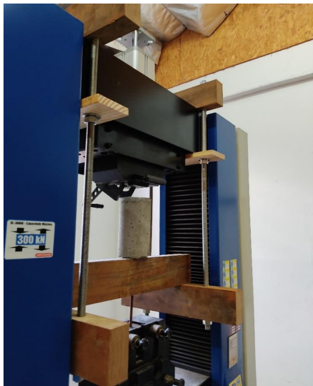
Figura 52 - Arranjo para execução do ensaio de arrancamento
