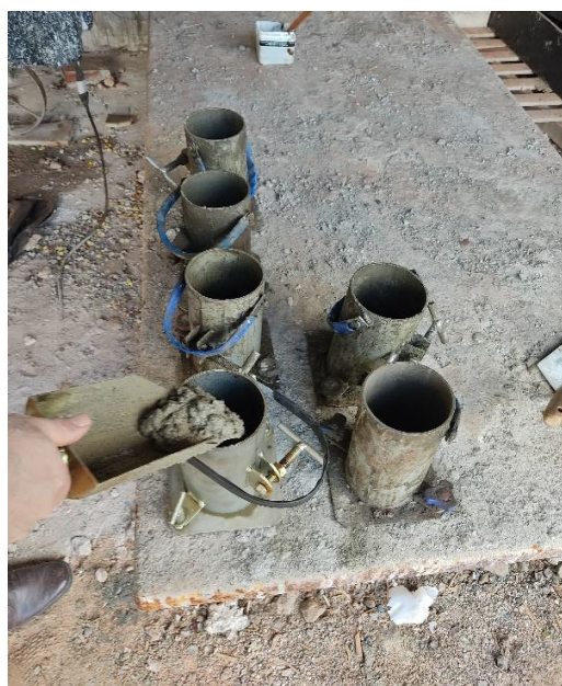
Figura 46 - Preenchimento de 1/3 de cada molde
