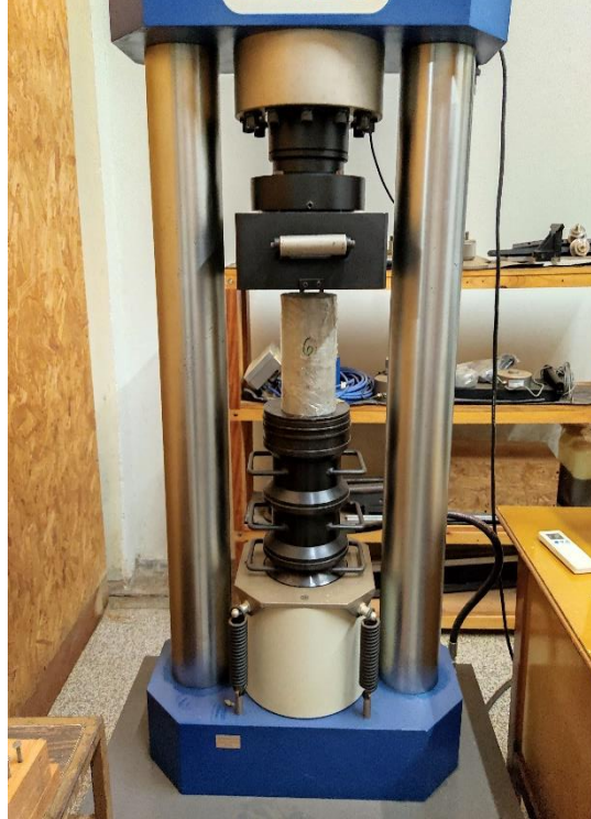
Figura 54 - Ensaio de resistência à compressão axial
