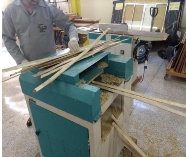
Figura 38 - Uniformização da espessura pela plaina desengrossadeira
