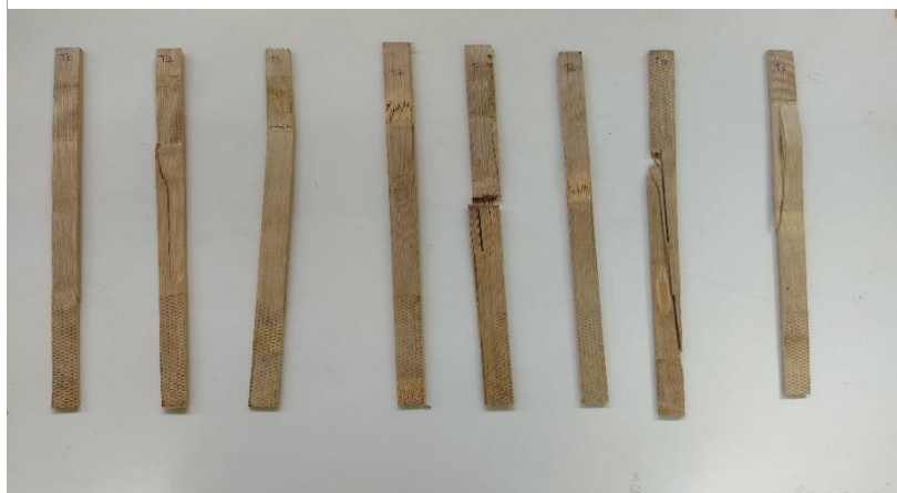
Figura 55 - Taliscas de bambu rompidas por tração
