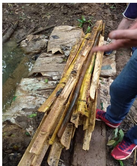
Figura 34 - Formação de limo nos bambus
