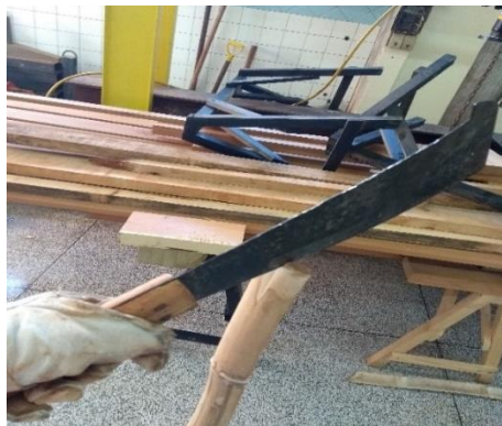
Figura 37 - Corte das tiras de bambu
