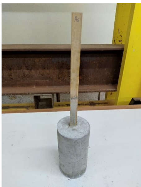
Figura 58 - Escorregamento da talisca de bambu (A5)
