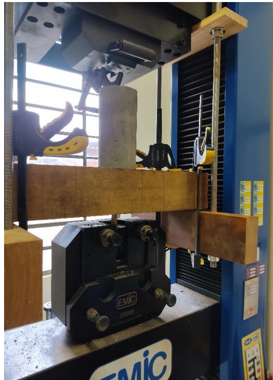
Figura 53 - Arranjo para execução do ensaio de arrancamento em talisca de bambu
