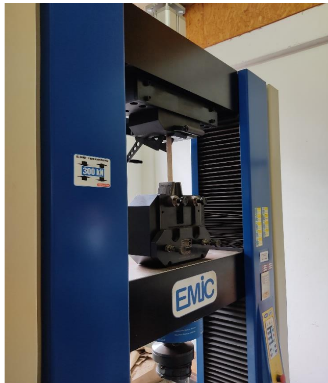
Figura 50 - Ensaio de resistência à tração axial talisca de bambu
