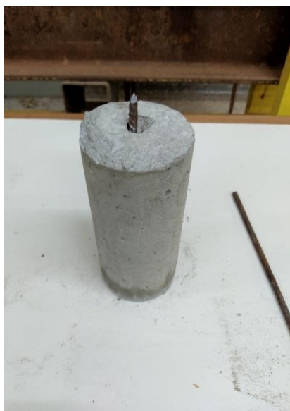
Figura 64 - Ruptura da barra de aço 1 de 8,0 mm
