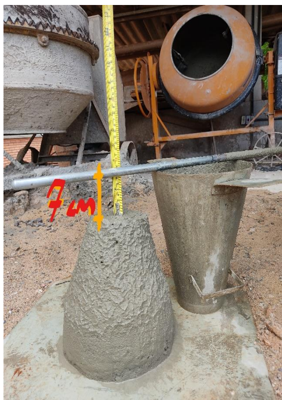
Figura 44 - Slump Test – abatimento obtido
