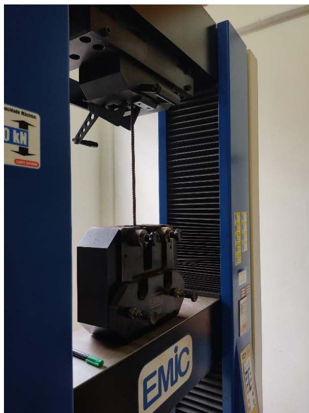
Figura 49 - Ensaio de resistência à tração axial em barra de aço de diâmetro 8,0 mm
