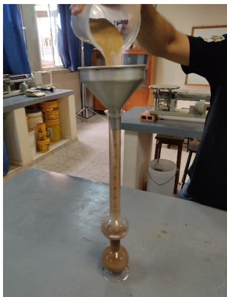
Figura 21 - Adição da areia no frasco de Chapman
