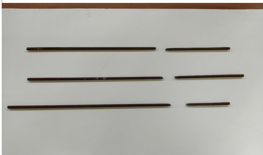
Figura 56 - Barras de aço de 8,0 mm rompidas após ensaio
