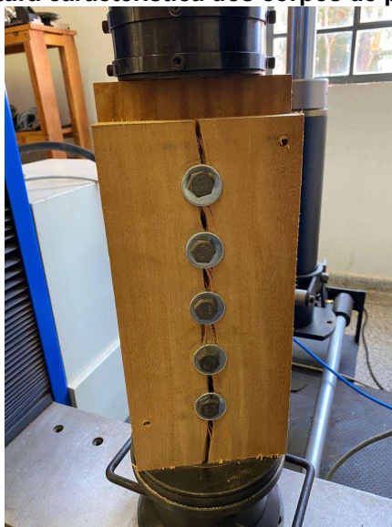
Figura 13 - Ruptura característica dos corpos de prova de ligação.
