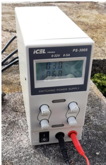
Figura 7 - Fonte de corrente contínua.
