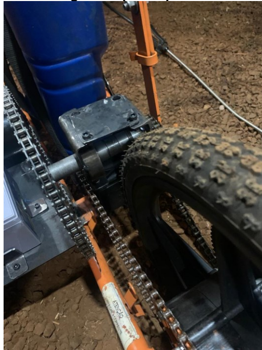
Figura 27 - Foto de montagem do protótipo com detalhe para a redução
