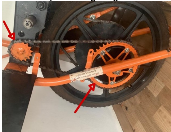
Figura 13 - Foto com detalhe para as engrenagens existentes no equipamento
