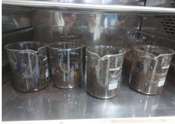
Fotografia 1: Estufa de secagem das amostras
