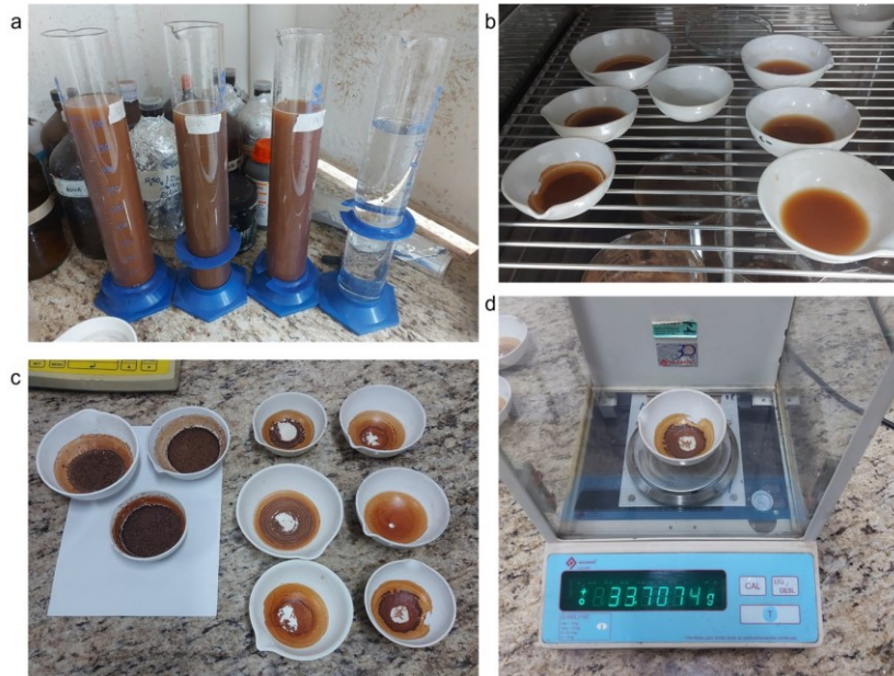
Figura 8: Procedimentos experimentais para a determinação dos teores de argila e silte do sedimento, Provetas com volume de 500 mL, contendo dispersante e solo (a), Estufa de secagem (b), material seco (c), pesagem das amostras (d).
