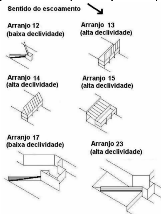
Figura 22: Estrutura para retenção autolimpante
