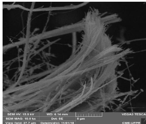
Figura 9 – Imagens e EDS pontual do padrão de crisotila usada para fins comparativos
