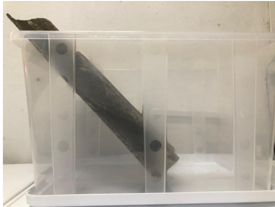
Fotografia 4 – Esquema do processo de lavagem da chuva sintética e chuva natural na telha de fibrocimento
