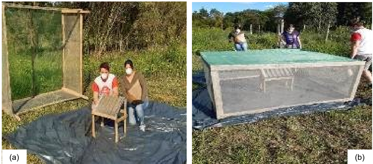
Fotografia 7 – Instalação da caixa contendo amostra de telha (TIP) no assentamento Contestado onde (a) demonstração da estrutura da telha e (b) instalação completa do sistema para a coleta do material particulado
