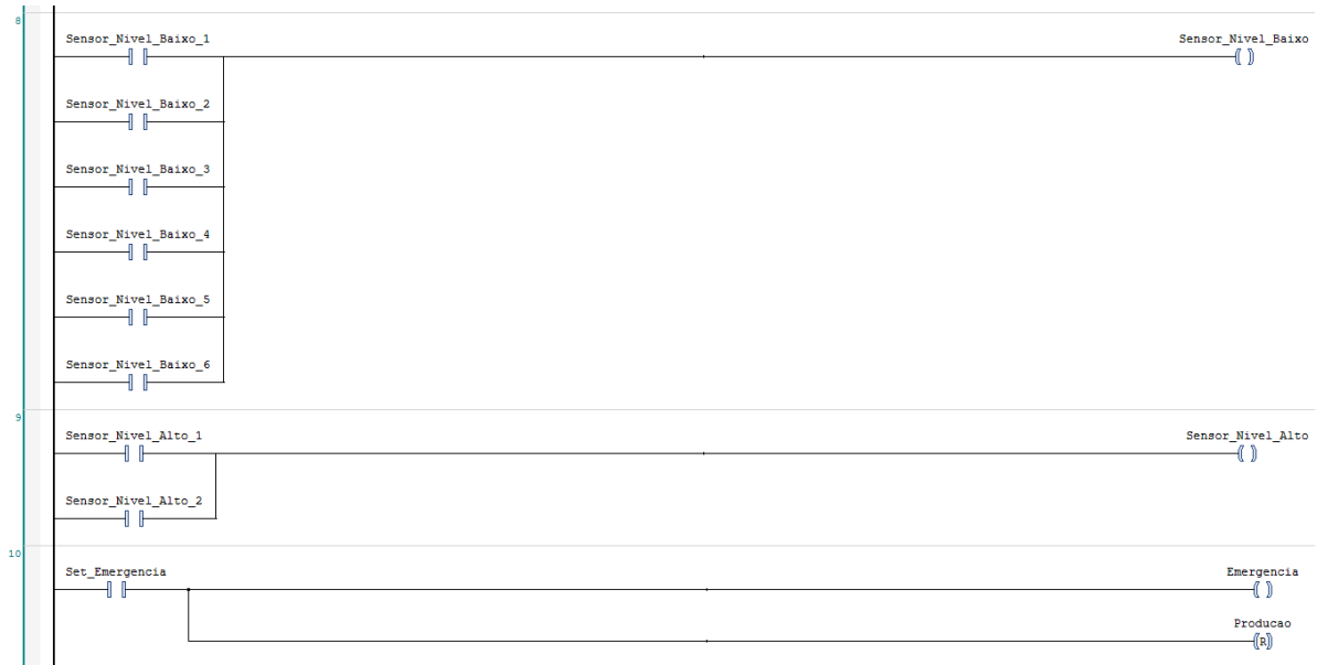
Figura 28 – Proteção - Emergência e Sensores de Nível
