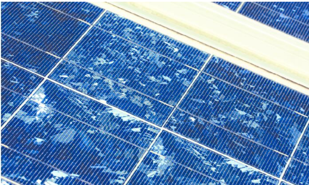
Figura 7 - Módulo Fotovoltaico de Silício Policristalino
