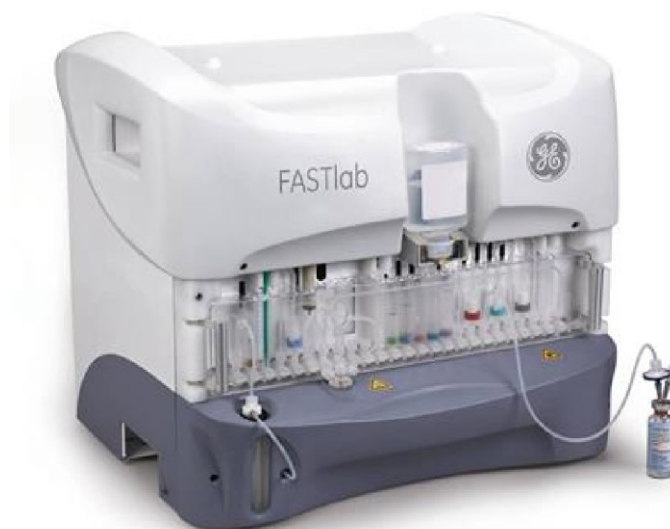
Figura 8 - Sintetizador FASTLab da GE HealthCare
