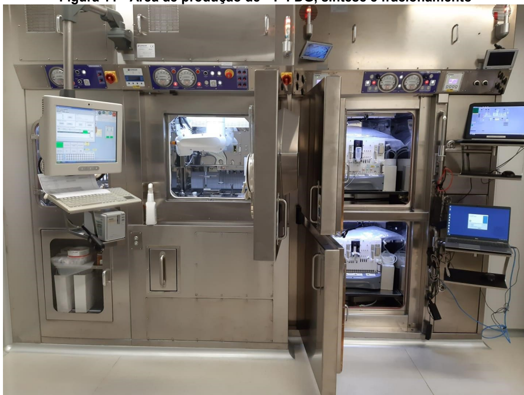
Figura 11 - Área de produção de ^{18}\text{F} -FDG, síntese e fracionamento
