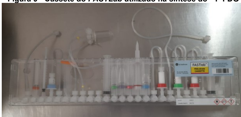
Figura 9 - Cassete do FASTLab utilizado na síntese do ^{18}\text{F} -FDG
