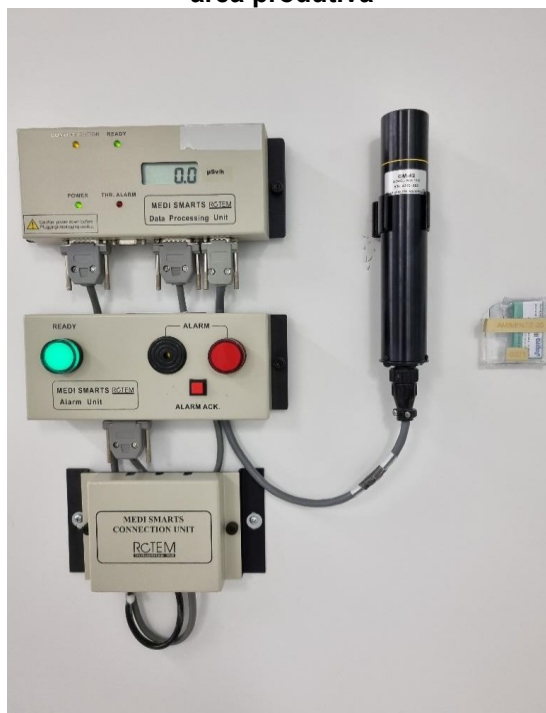
Figura 24 - Monitor de parede e dosímetros de área que registram as taxas de exposição na área produtiva
