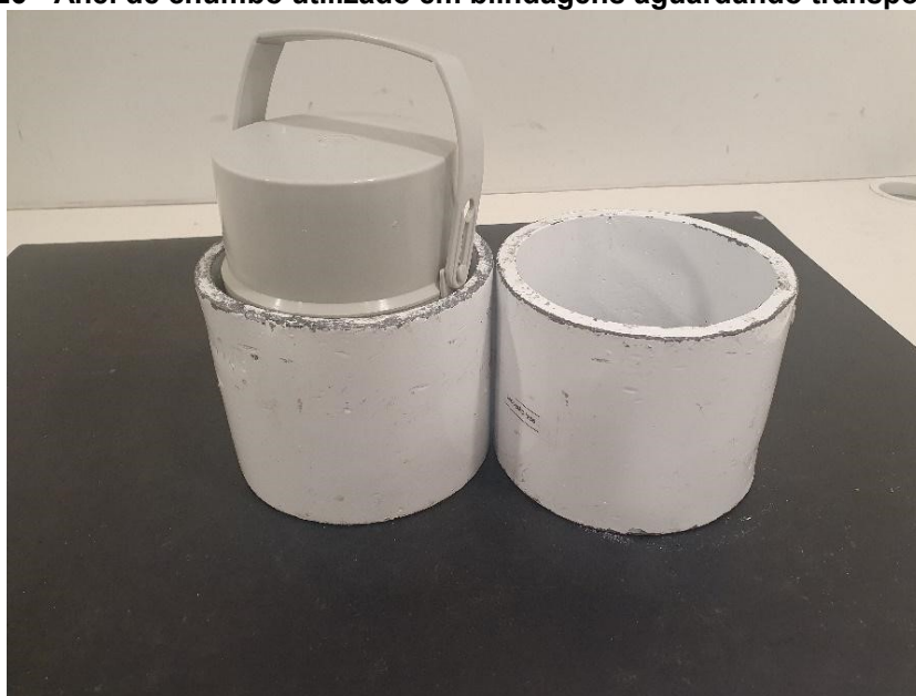
Figura 26 - Anel de chumbo utilizado em blindagens aguardando transportadoras
