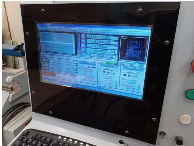
Figura 12 – Tela da CNC com o desenho do corte
