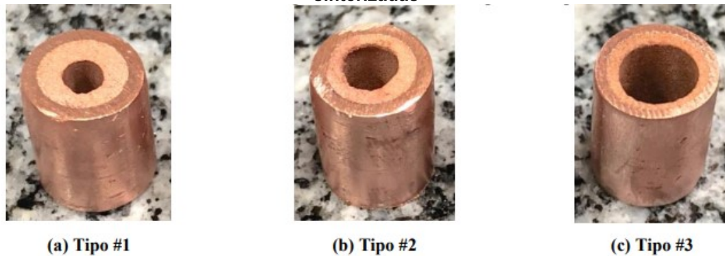
Fotografia 3 - Amostra das diferentes configurações de estruturas capilares de pó de cobre sinterizadas
