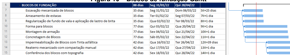
Figura 10 – Blocos de fundação Gantt
