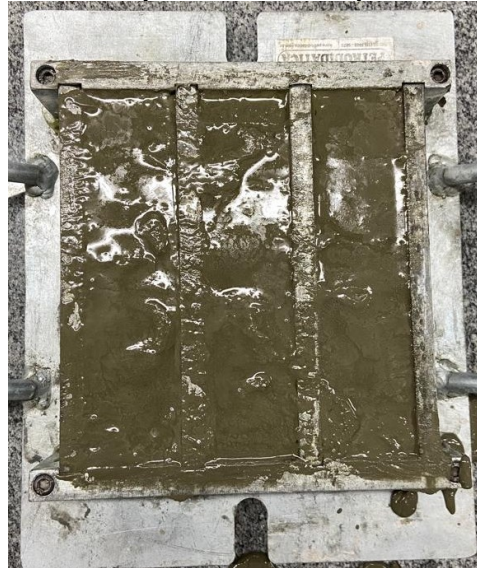
Figura 8 - Molde preenchido com pasta cimentícia
