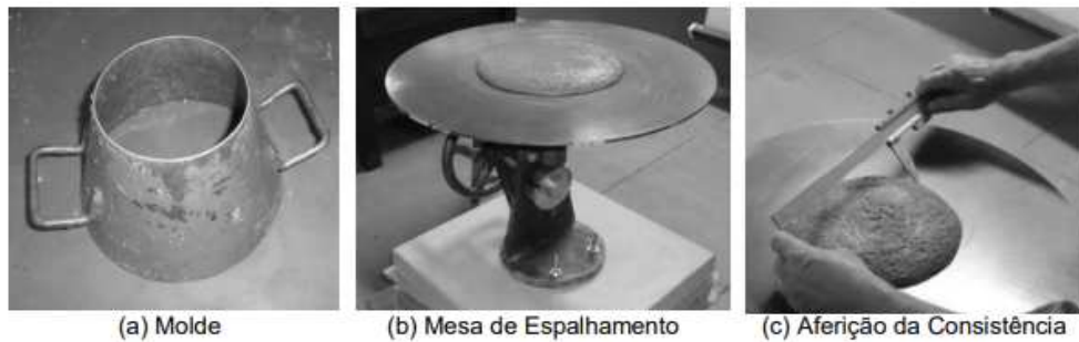
Figura 2 - Mesa de espalhamento para o ensaio de consistência ( flow table ).
