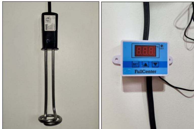
Figura 18 – a) Resistência para aquecimento, b) Controlador de temperatura do sistema.
