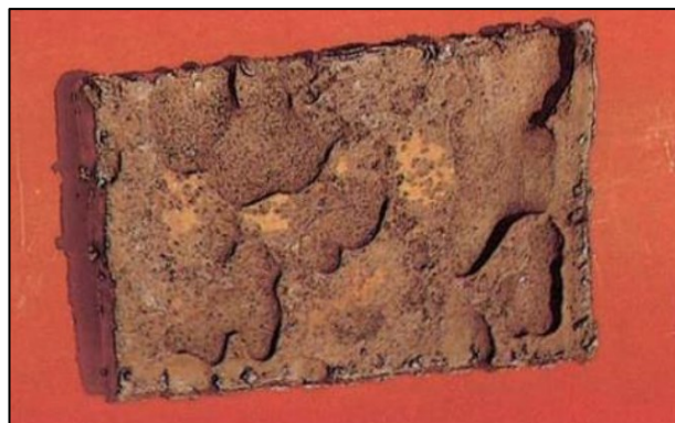
Figura 5 – Corrosão por placa em aço carbono
