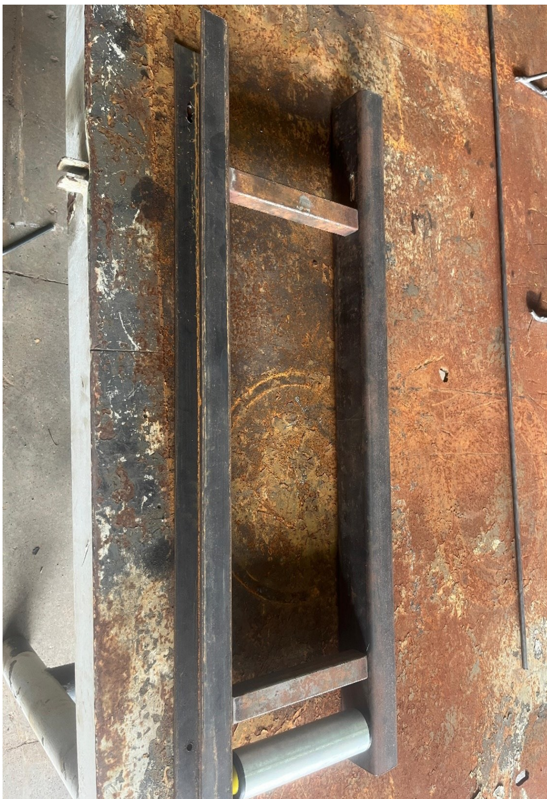
Figura 6 - Esteira em processo de montagem
