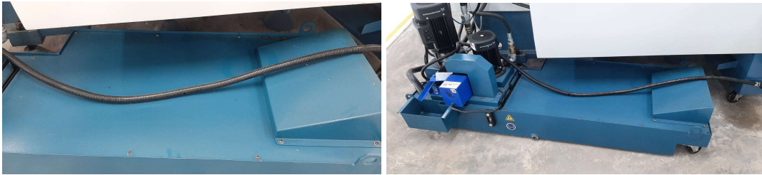
Figura (21) - Reservatório do sistema de refrigeração
