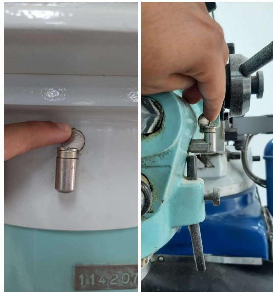
Figura (39) - Lugares para aplicar o lubrificante da caixa de engrenagens
