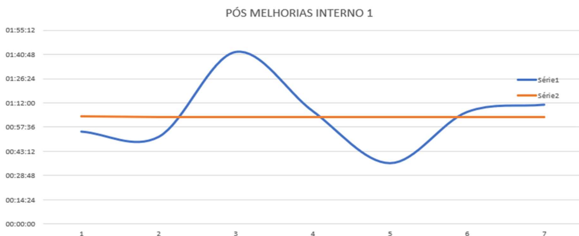
Gráfico 6 - Tempo demandado no acabamento interno 2 por carroceria, com dados filtrados após as melhorias
