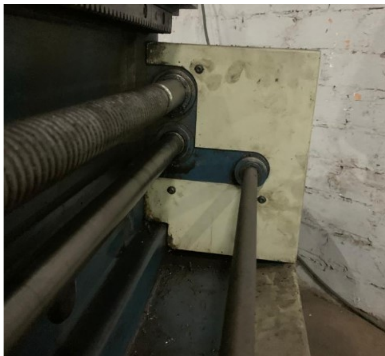
Figura 13 – Fuso de movimentação exposto.
