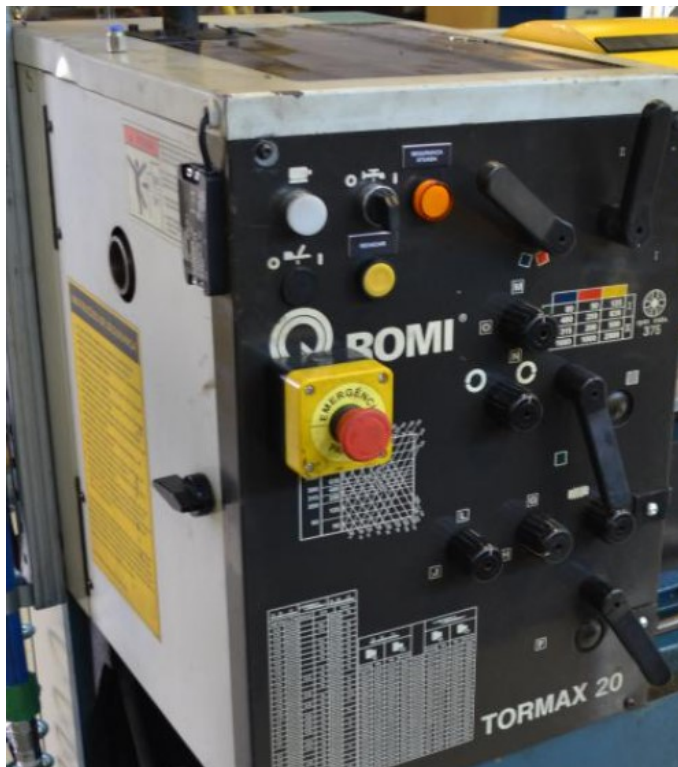
Figura 22 – Botão de parada de emergência no painel principal.
