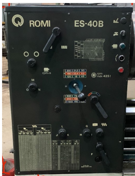
Figura 7 – Painel de definição de parâmetros de trabalho.
