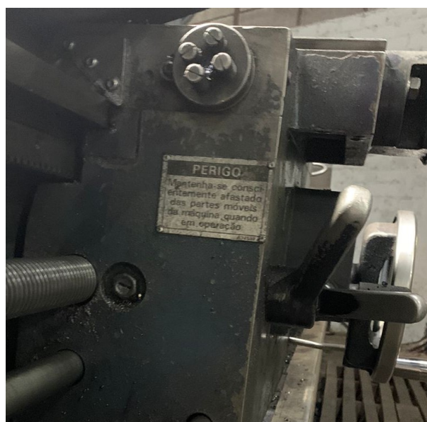
Figura 11 – Aviso para afastamento do carro de desbaste durante o movimento.
