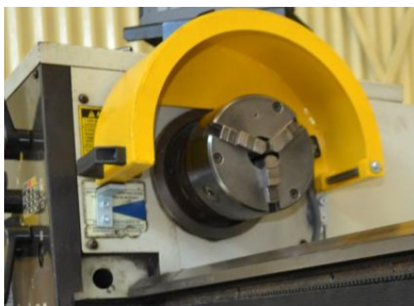
Figura 16 – Proteção para castanha de fixação de peças a serem usinadas.
