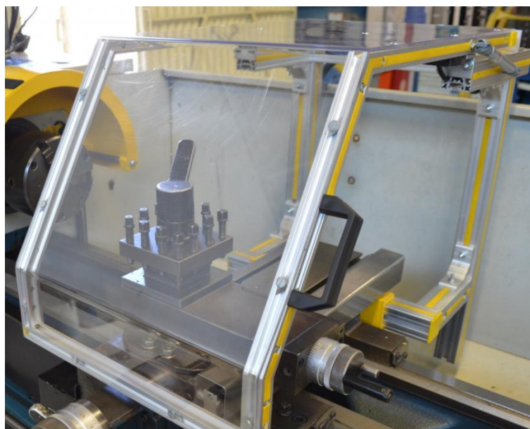
Figura 20 – Proteção para componente de desbaste em usinagem.
