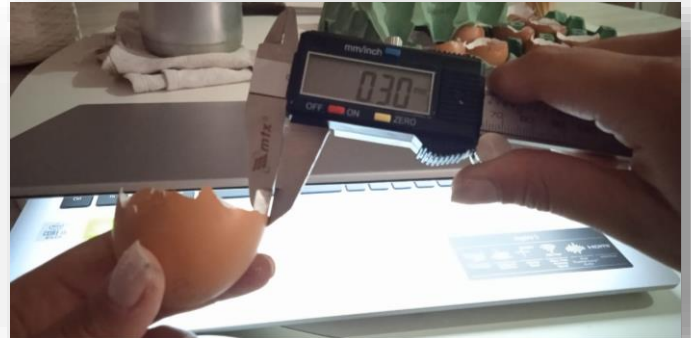
Figura 11: Medição da espessura da casca.
