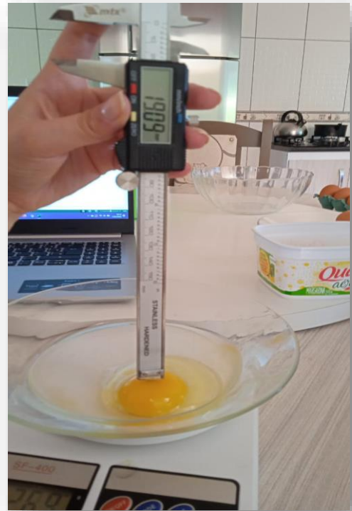
Figura 4: Medição da altura da gema.
