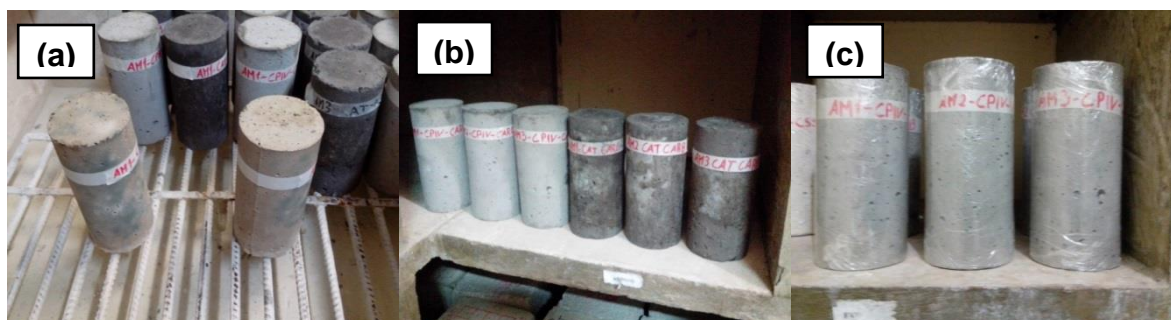
Figura 34 – Fases de preparação amostras de concreto (a) cura úmida; (b) constância de massa e (c) redistribuição de umidade.
