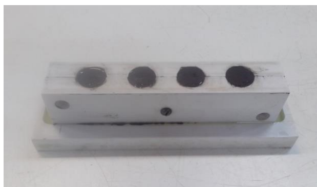
Figura 41 – Amostras de pastas moldadas em moldes cilíndricos 25mm x 40mm.
