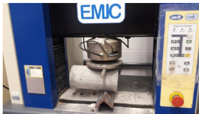
Figura 35 – Método de extração de discos 100mm X 50mm de corpos de prova de 100mm X 200mm.
