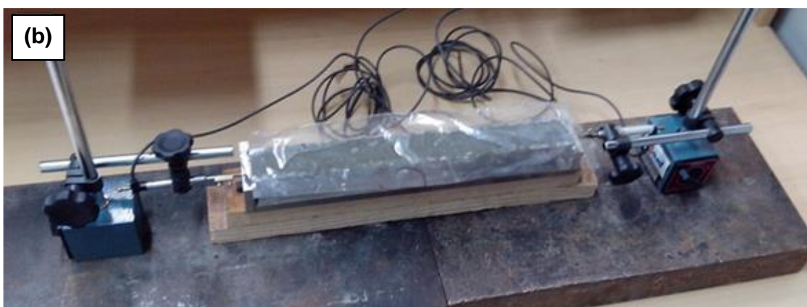
Figura 28 – Adaptação de equipamento de medida de retração de argamassa no estado fresco (a) desenho esquemático e (b) equipamento de ensaio.
