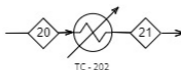
Figura B 4 – Sistema de troca térmica sem integração energética do solvente com impurezas
