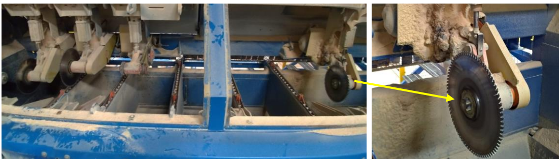
Figura 10 - Serras circulares para operações de destopo ( trimmer ).
