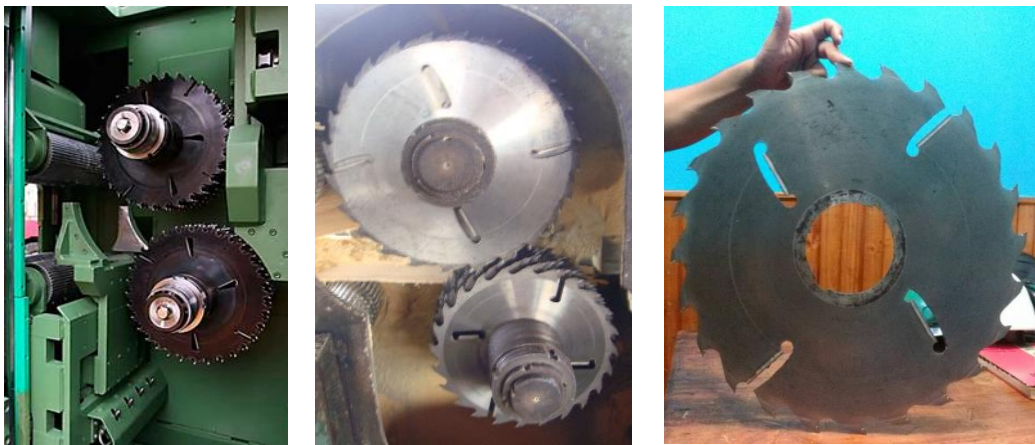
Figura 13 - Esquerda e Centro: Serras circulares de eixos duplo. Direita: Corpo da serra circular.
