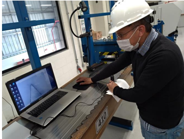
Figura 21 – Medição do desgaste por microscopia ótica
