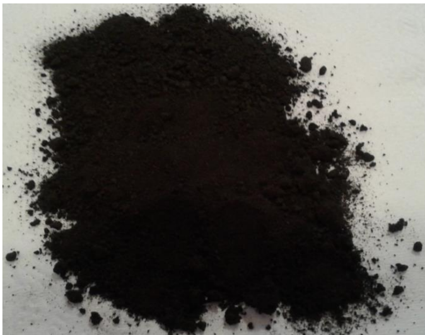
Figura 8. Material obtido PAC-FVZ após etapas de síntese, imobilização, lavagem e secagem
