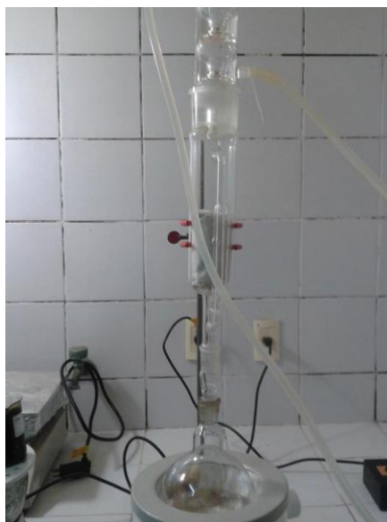
Fotografia 4 - Sistema de extração Soxhlet montado
