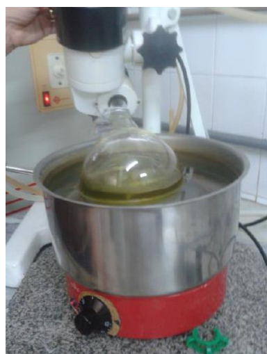
Fotografia 5 - Separação do óleo do solvente no rota-evaporador Fisatom 802
