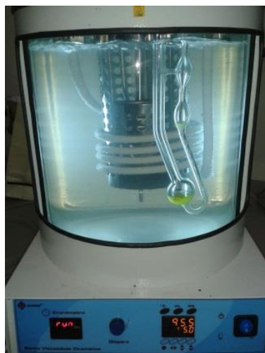
Fotografia 6 - Viscosímetro dentro de banho à 95°C
