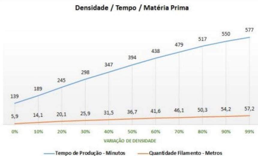
Figura 4 - Variação do tempo de impressão com diferentes valores de preenchimento
