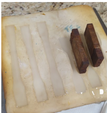
Figura 10 - Moldes de silicone preenchidos com a mistura de TDI e TEA
