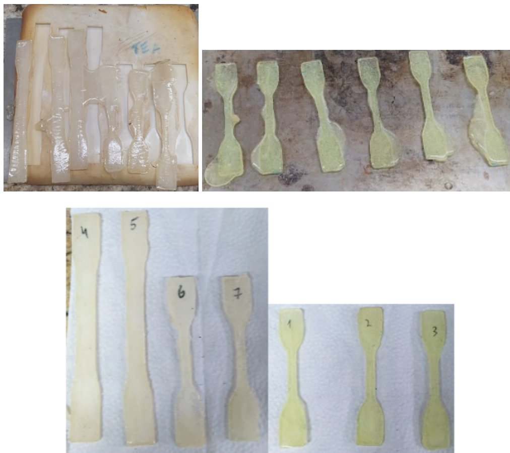
Figura 11 - Corpos de prova após a pós-cura (com rebarbas acima, sem rebarbas abaixo) TEA à esquerda e MOCA à direita
