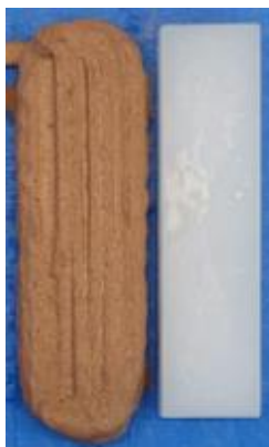
Figura 36 - Corpo de prova impresso com bico de 3 mm
