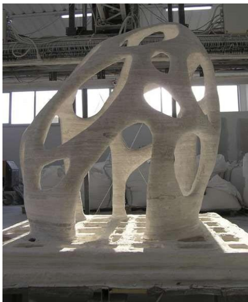
Figura 2 - Exemplo de impressão por D-Shape
