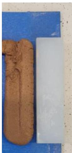
Figura 35 - Corpo de prova impresso com bico de 8 mm
