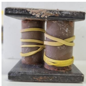
Figura 14 - Moldagem do corpo de prova cilíndrico
