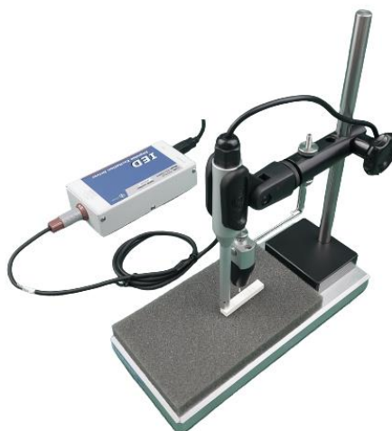
Figura 15 - Suporte SB-AP Sonelastic
