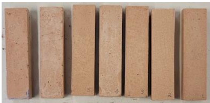
Figura 31 - Corpos de prova desmoldados
