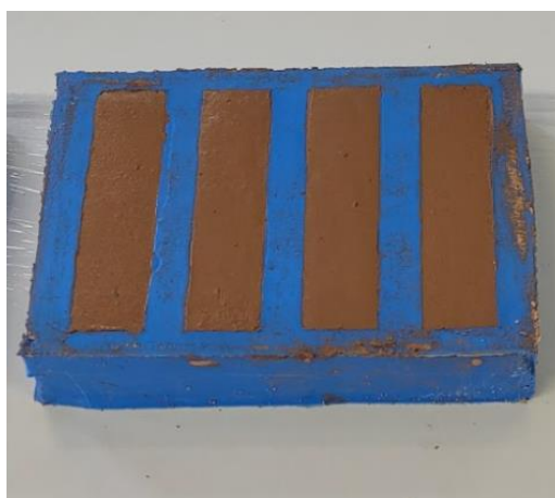
Figura 13 - Molde de silicone preenchido
